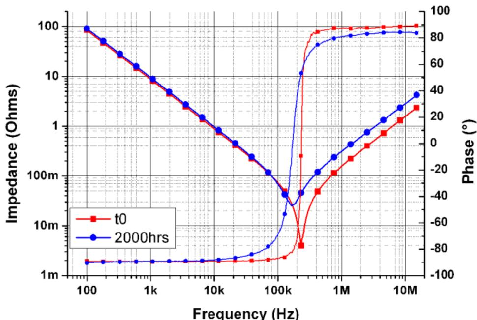
Effet du vieillissement sur la capacité et sur le facteur de dissipation.
