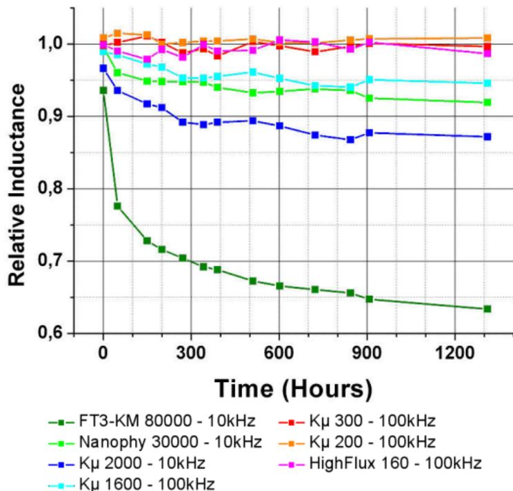
Les matériaux haute permeabilité sont le plus affectés par le vieillissement à 200 °C
