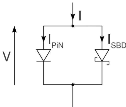
Modèle électrique en conduction : deux diodes en parallèle :
