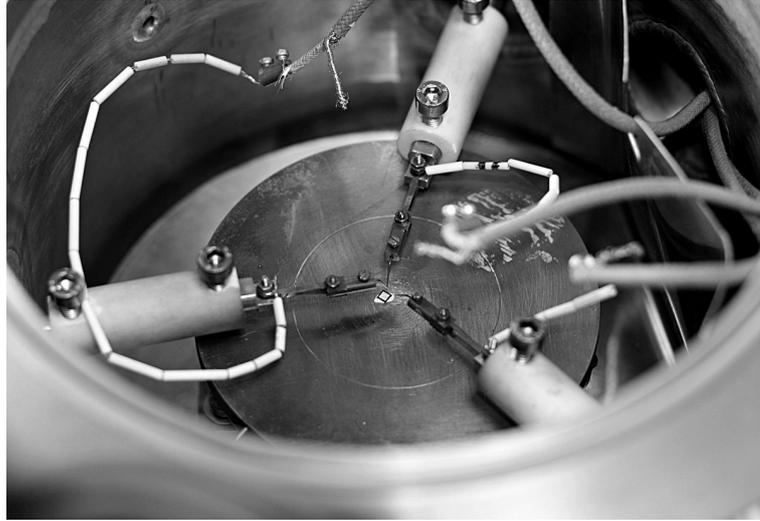
FIGURE 7.3 – Dispositif de caractérisation sous vide, permettant de chauffer une puce nue et de venir prendre des contacts à l'aide de micromanipulateurs équipés de pointes. La diode MPS sous test est visible au centre de l'image.
